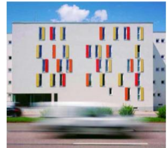
Die Richtung OdH ausgerichteten Fassaden werden hinsichtlich ihres Durchfensterungsgrades und der Schallschutzqualität der Fenster entsprechend angepasst. Wohnhaus in München; Zornedinger Straße 12 - 38, Felix + Jonas Architekten
